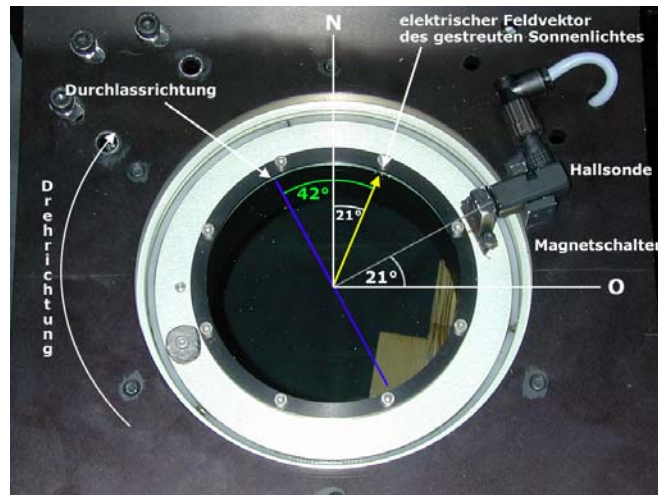
Abbildung 5.4: Bestimmung der Winkeldifferenz zwischen der Durchlassrichtung des Polarisators und dem Winkel des elektrischen Feldvektors am Himmel. Blickrichtung ist vom Teleskop aus. Die Durchlassrichtung steht senkrecht auf der Achse Filtermittelpunkt-Magnetschalter-Hallsonde. Der eingetragene Wert für die Winkeldifferenz zwischen Durchlassrichtung und elektrischem Feldvektor des gestreuten Lichts stammt aus den theoretischen Überlegungen und weicht um 4^\circ vom anhand der Sonnenaufgangsmessungen bestimmten Wert von 45^\circ ab.
