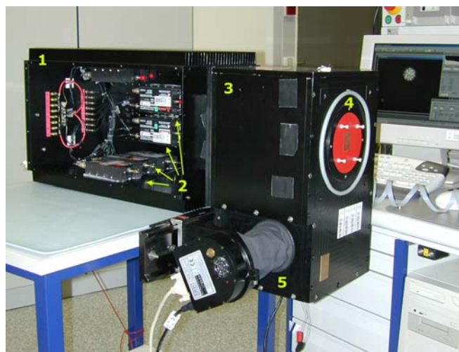
Abbildung 3.1: Das Optima Detektorsystem. 1.Hochgeschwindigkeitsphotometer, 2. Avalanche Photodioden, 3. CCD-Fokalaufblicksmodul, 4. Adapter zum Teleskop, 5.CCD-Kamera
