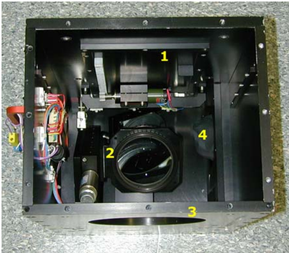
Abbildung 3.4: Bild des CCD-Fokalmoduls. 1. Shutter zum Öffnen und Schließen, 2. Teleobjektiv zur Regulierung des Bildausschnittes, 3. Öffnung zur Durchführung des Keilspiegels, 4. Öffnung für CCD-Kamera
