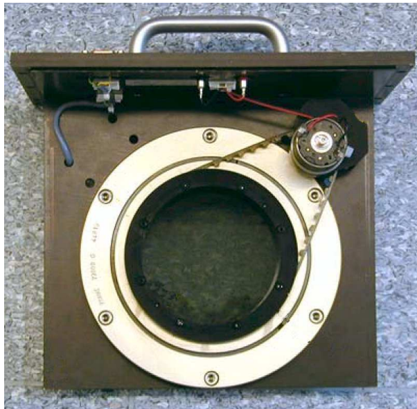
Abbildung 3.8: Das OPTIMA-Polarisationsfilter. Abgebildet ist die der CCD zugewandte Antriebsseite. [Kel02]
