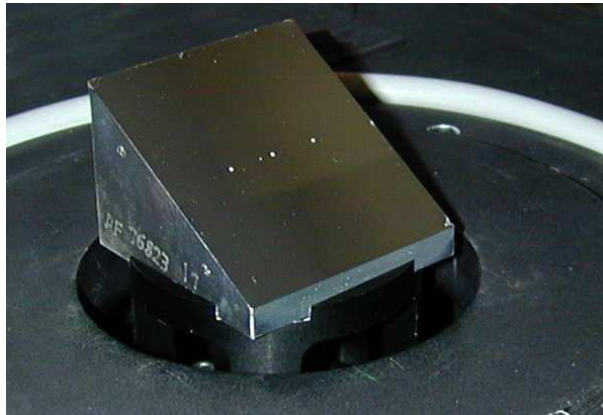
Abbildung 3.5: Der OPTIMA-Keilspiegel. Gut zu erkennen, die Durchführungen der Glasfasern. Es handelt sich bei dem hier abgebildeten Spiegel um ein älteres Modell, noch ohne Bohrungen für die Positions-Fasern.
