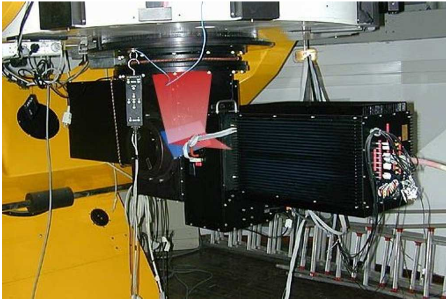
Abbildung 5.9: Die alte GAM-Konfiguration. Farblich angedeutet der um 90^\circ geknickte Strahlengang.
