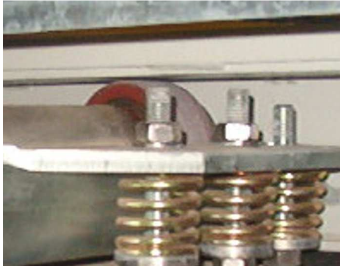
Abbildung 5.3: Nahaufnahme einer Antriebseinheit. Gut zu erkennen, das verschlissene Antriebsrad.
