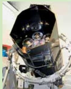
Das eROSITA-Instrument des MPE wurde speziell dafür entwickelt, den gesamten Himmel mit seinen sieben Röntgenteleskopen abzurastern. Jedes enthält 54 ineinander geschachtelte Spezialspiegel. Sein großes Gesichtsfeld in Verbindung mit seiner hohen Empfindlichkeit für Röntgenstrahlung lässt die genaueste vollständige Himmelskarte im Röntgenbereich erwarten.
