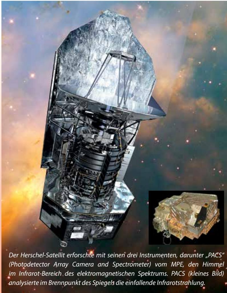
*Der Herschel-Satellit erforschte mit seinen drei Instrumenten, darunter „PACS“ (Photodetector Array Camera and Spectrometer) vom MPE, den Himmel im Infrarot-Bereich des elektromagnetischen Spektrums. PACS (kleines Bild) analysierte im Brennpunkt des Spiegels die einfallende Infrarotstrahlung.*
