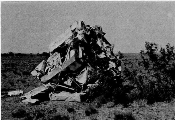
Abb. 5: Oftmals ist die Nutzlast nach der Landung arg ramponiert, aber die Hauptsache ist, daß die Meßdaten erhalten sind und ausgewertet werden können.
