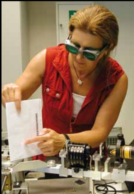
Feinabstimmung eines Lasergeräts um die Qualität der im MPE-Labor hergestellten Spiegel für eROSITA zu testen.
