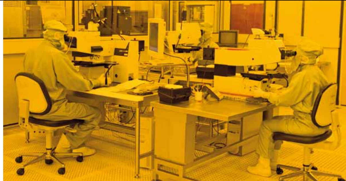
Mitarbeiter des MPI Halbleiterlabors führen optische Qualitätsprüfungen im Reinraum durch. Die gelbliche Beleuchtung beeinträchtigt die lichtempfindlichen Wafer nicht.
