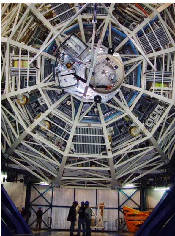
Anfang 2003 ging unser abbildendes Nahinfrarotspektrometer SPIFFI erstmals am Großteleskop VLT der ESO in Chile in Betrieb (Abb. 3-3). SPIFFI ermöglicht abbildende Spektroskopie eines zusammenhängenden, zweidimensionalen Bereichs von 32 x 32 Bildelementen im Wellenlängenbereich von 1.1-2.45  $\mu\text{m}$  bei einer spektralen Auflösung von 1300-3500. Das Ergebnis ist ein simultaner Datenkubus mit zwei räumlichen und einer spektralen Dimension.
