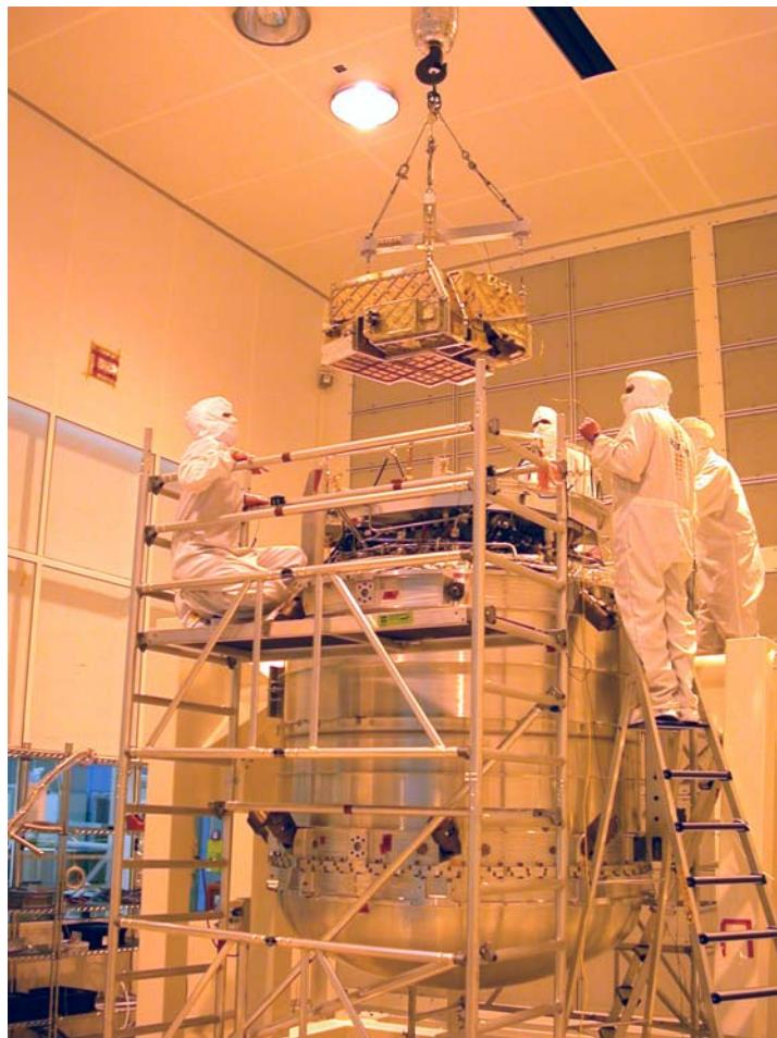
*Abb.: 3-7: PACS beim Einbau in den Kryostaten für den EQM-Test.*
