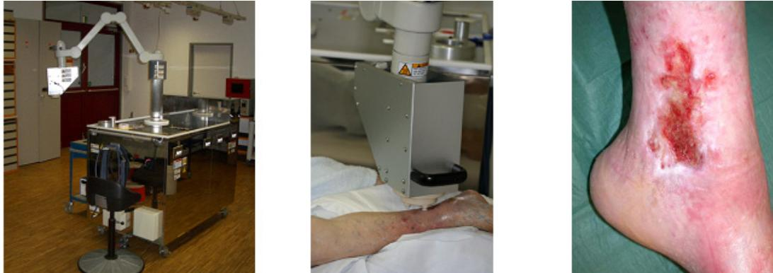
*Abb. 3-21: Plasmagerät aus der klinischen Studie (links). Der bewegliche Arm erlaubt das Positionieren der Plasma-Torch über dem zu behandelten Wundbereich. Für eine objektive und reproduzierbare Evaluierung des Heilungsprozesses werden die Wunden quantitativ mit Bildanalyseverfahren bewertet.*
