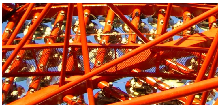
Abbildung 3.6: Links: Blick von hinten auf einen Teil des Spiegelträgers. Die einzelnen Spiegel sitzen auf Metallrohren. Rechts: Blick von hinten auf einen Spiegel. Man erkennt die beiden Aktuatoren sowie das verwindungssteife Aluminum-Dreieck, auf das der Spiegel geklebt ist.
